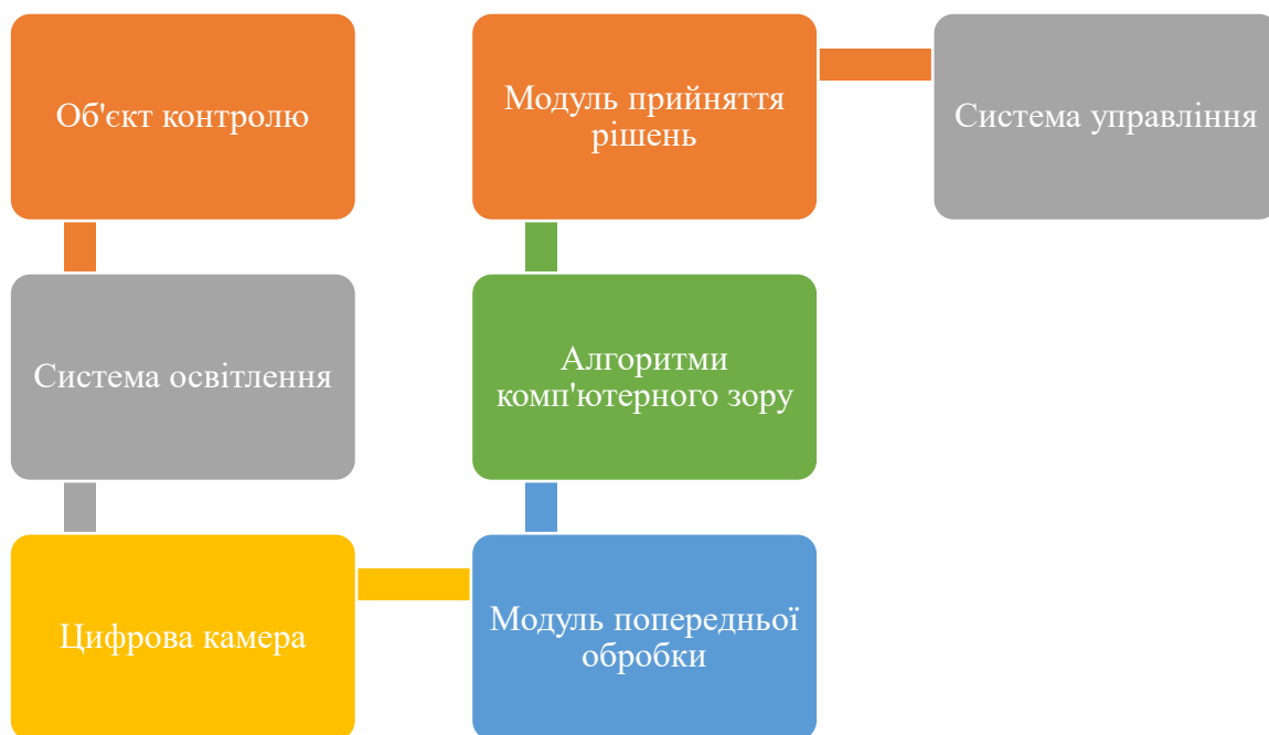
Рис. 1. Структурна схема автоматизованої системи контролю якості на основі комп'ютерного зору
